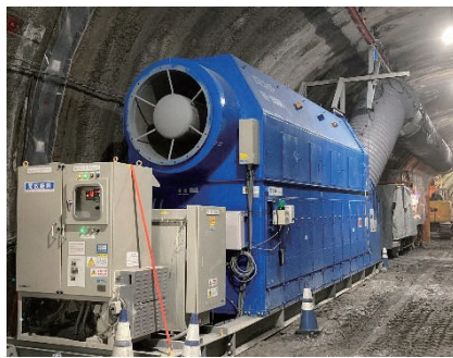
写真-2 集塵機 (110kW)
