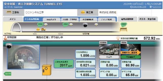
図-12 システムによる管理画面（作業状況）
