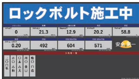
図-10 作業工程表示（ロックボルト）
