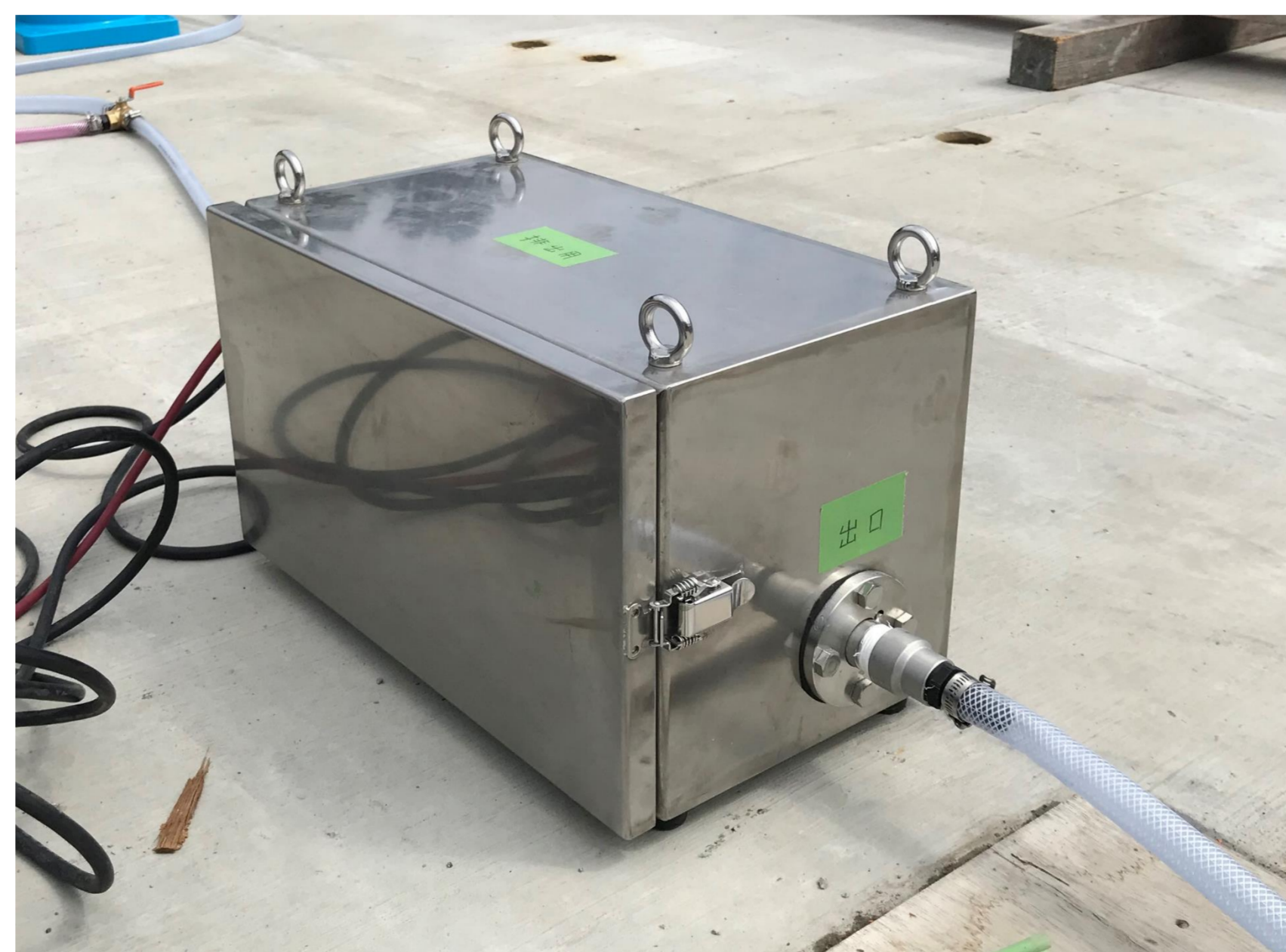
注入管理装置
