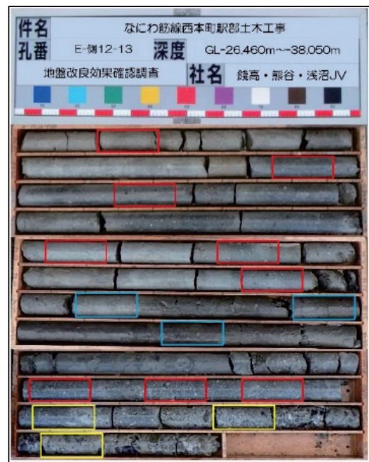
写真－1 コアボーリング試料
