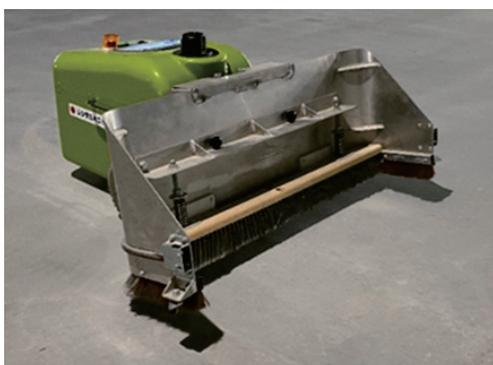
写真-4 自立型清掃ロボット T0 ギャザー
