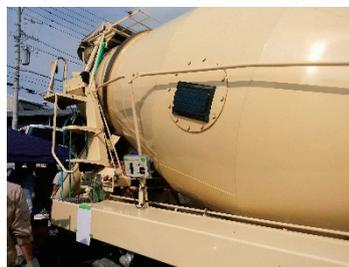
写真-1 コンクリート連続管理装置
