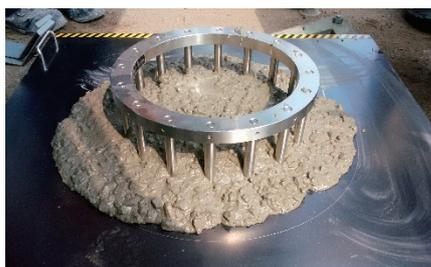
写真-7 Jリングフロー試験状況
