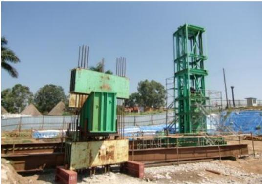
写真-3 静的載荷試験装置(左側)と衝撃載荷試験装置(右側)
