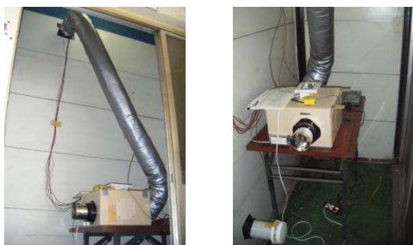
写真-3 集熱パネルの計測状況
