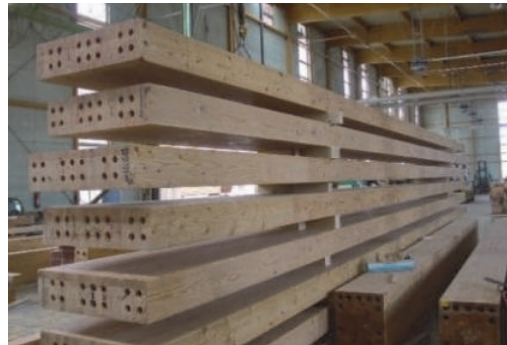
写真-21 大断面集成材完成状況
