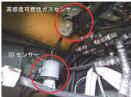
写真-4 ガスセンサー (本質防爆、シールド機内)
