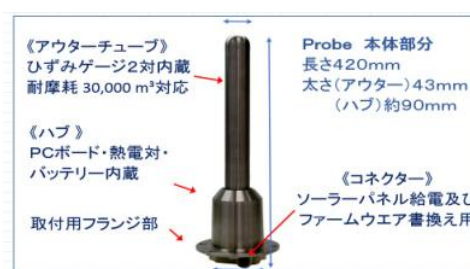
図-1 プローブの構造
