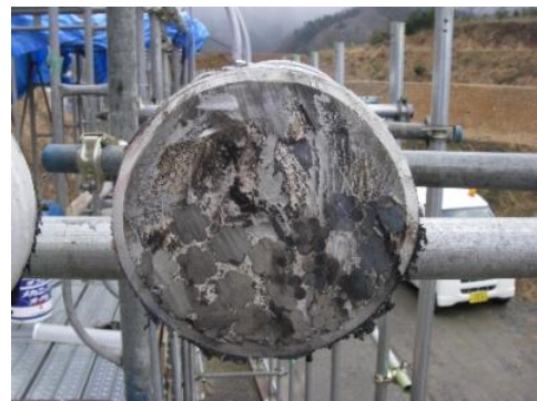
写真-10 切断した試験体の充填状態
