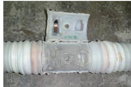
写真-4 試験体内部の充填状態
