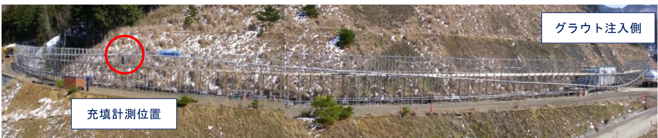
写真-5 実物大グラウト充填試験
